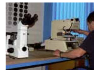
Měření tvrdosti jádra a povrchu
