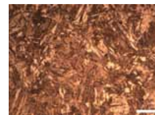
Kontrola struktury materiálu po tepelném zpracování
